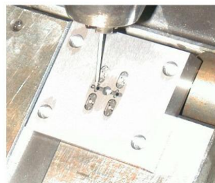
携帯電話押しボタン金型加工中
